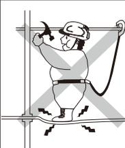
5. フックは、可能な限り、墜落した場合に振り子状態になって物体に激突しないような場所に取付けてください。
