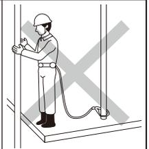
2. ランヤードに表示された落下距離を確認し、それ以下の位置で作業を行わない。墜落阻止時に床面又は下方の障害物に接触する恐れがあります。
